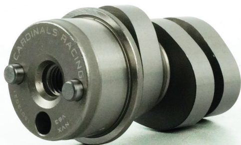
NAME : RACING VVA CAM V63 CODE : CSRV63NVX COLOUR : - MODEL : NVX/N - MAX NOTE : IN:2.63 / EX:2.41 XXBBJXX
